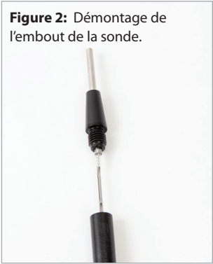
Figure 3: Le démontage de l'embout permet le nettoyage de la brosse-filtre.
